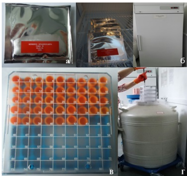
А – семена в пакетиках из ламинированной фольги; Б – морозильная камера Sovitalprod mash СВ107-S ШН - 0.7, температурный режим: (-18)-(-20)^\circ\text{C} ; В – криобокс с криопробирками, заполненными семенами барбариса; Г – погружение держателей с криобоксами в Дьюар с жидким азотом при температуре -196^\circ\text{C}
